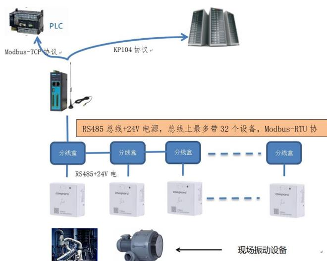
图 13. 智能温振传感器有线通讯的接线方案
