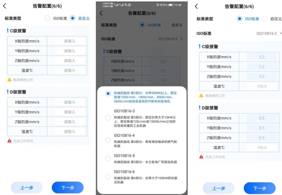
图 24. 向导模式的告警配置界面
