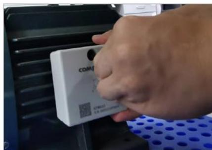
图 11. 智能温振传感器平底固定图
