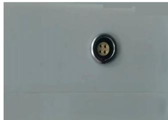
图 5. 智能温振传感器侧面接口图
