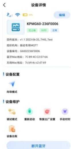
图 18. 温振传感器配置界面
