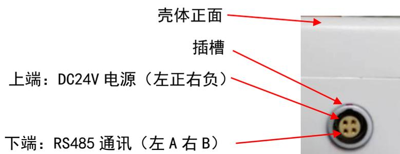
图 12. 智能温振传感器有线通讯的插接口
