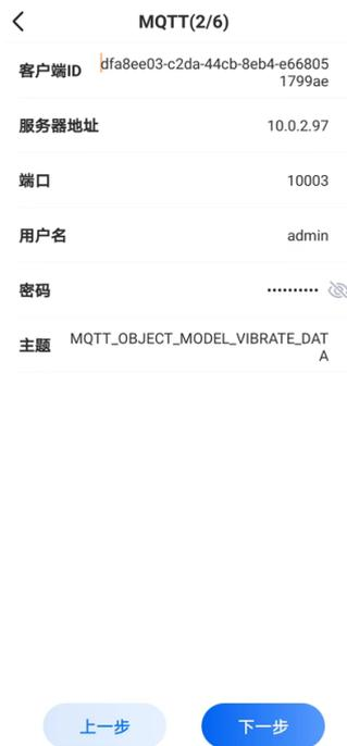
图 20. 向导模式的 MQTT 配置界面
